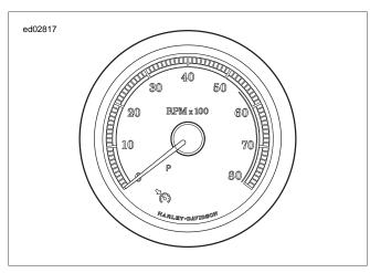
Figure 2-7. Tachometer
